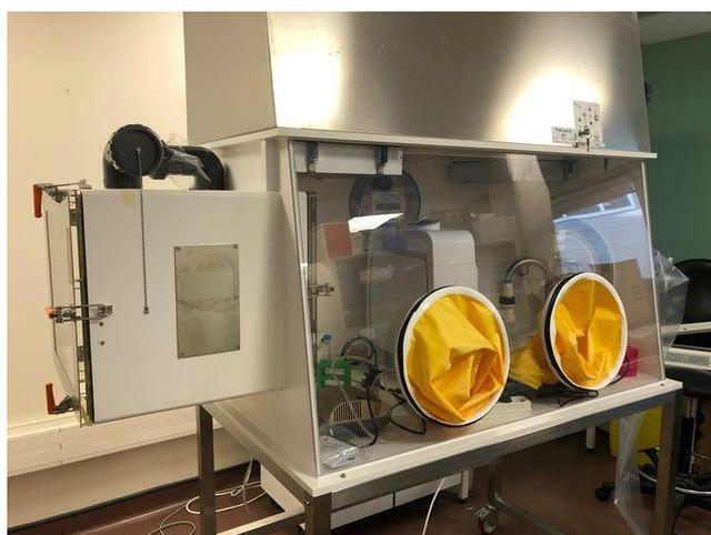
Figure 1 : EOLIS Air Manager installé dans le poste de Sécurité de Microbiologie de Classe III
